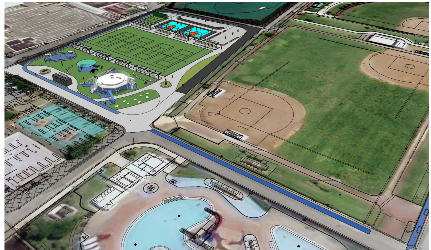
ウォーキングコースの新設（ゴムチップ舗装を基本とし、ウォーターガーデン前はカラー舗装）
